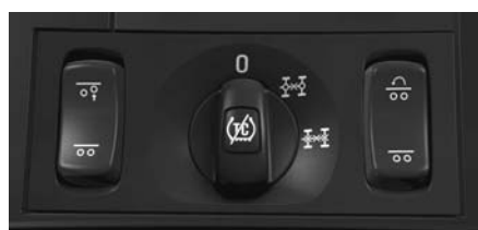
Traktionskontrolle: Drehschalter für Geländemodus betätigt
